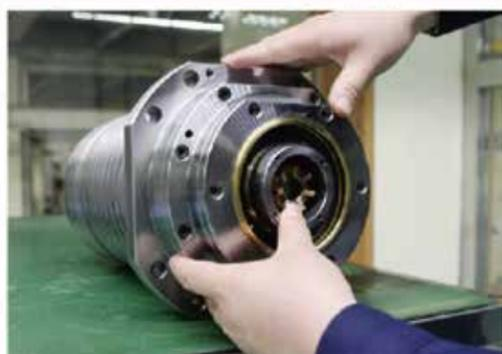
主轴精度检测 / Spindle accuracy test
