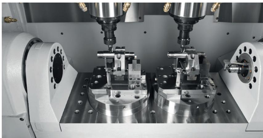
**DZ 12 S five axis:** 有限的空间内实现双倍的产能快速双主轴加工中心, 配置2轴数控转台 (AC轴), 用于工件的5轴联动高效加工。
