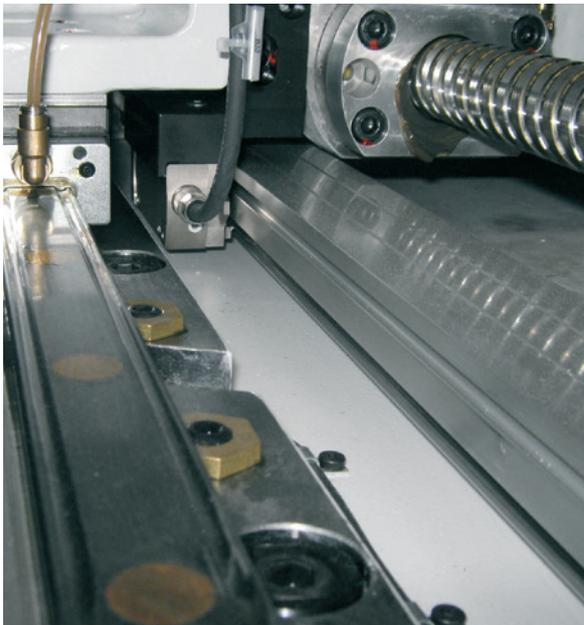
高精度加工:光栅尺和数字信号驱动技术,保障机床在快速加工的同时保障最佳的加工精度。
