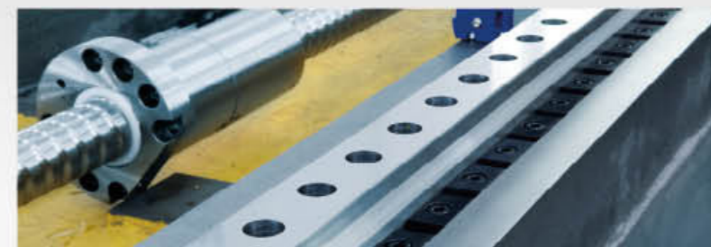
直联进给系统、滚柱直线导轨，达到 1G 加速度，实现进给轴高动态特性。
