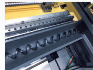
大斜度人字导轨防护、双螺旋式排屑系统，特别有利于大流量冷却液及铁屑排送。
