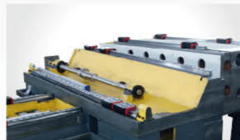
高低轨的阶梯结构形式，有效缩短力流线，抗倾覆能力强，移动部件轻量化设计，获得更好的加速性能。
