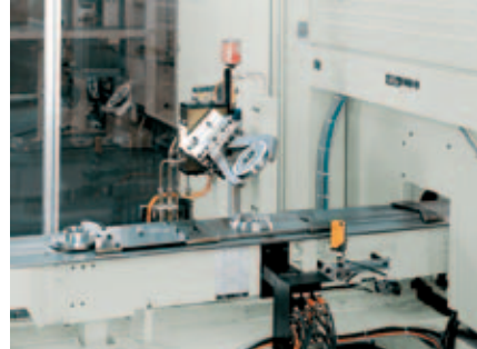
实例 VSC 250 DUO: 翻转单元对工件进行翻转，从而在第二次装夹后继续加工工件背面。
