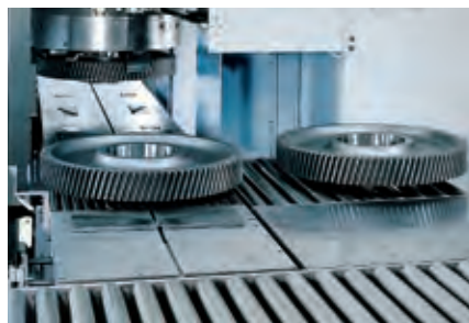
工件输送至自动上料工位并由卡盘接收
