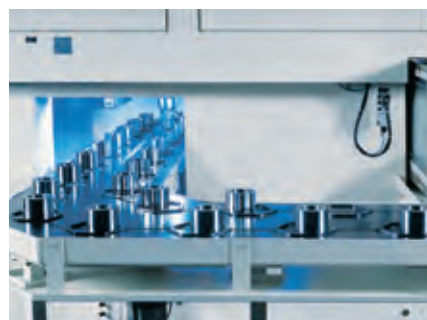
单机自动化输送系统：将毛坯件送至上下料工位，并将成品件送出
