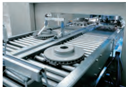
双轨上下料同步进行，工件更换更为迅速
